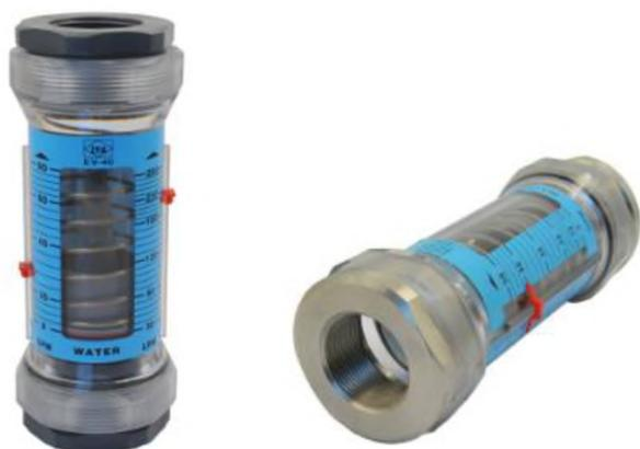
**Конструкция ротаметра изготовлена из высокопрочных инженерных пластмасс -поликарбонат или полисульфон, который устойчив к высоким температурам и коррозии. Позволяет устанавливать его в нескольких местах. выдерживает высокое давление. Рабочее давление 1.0 Мпа, рабочее давление меньше либо равно 1.0 Мпа, температура 0-80С, РСU:0-120С, точность +-6%**
