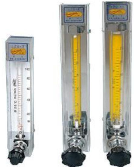
конкретного газа или жидкости. При применении ротаметров для других измеряемых сред вводят поправку на относительную плотность соответствующего газа или жидкости (относительно воды или воздуха соответственно).
